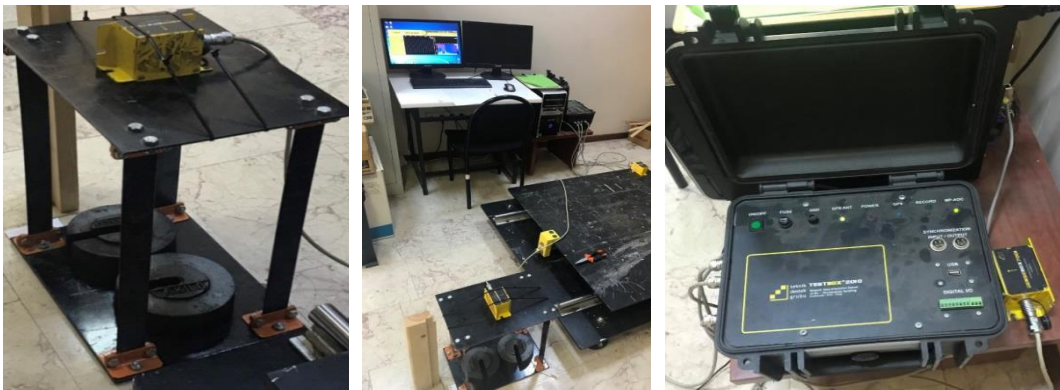
Şekil 2. Model Yapı, Test Düzeni ve Veri Toplama Cihazı
